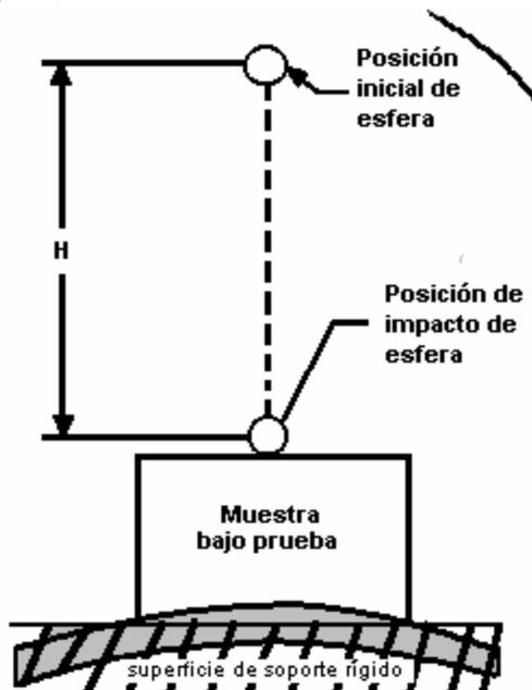
**FIGURA 6.- Prueba de impacto usando una esfera**
